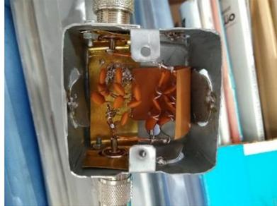
El conjunto posee agujeros de refrigeración como cualquier transmatch. A simple vista se ve que el dispositivo que construido excede los requerimientos para la tarea propuesta y eso compensa la baja calidad de los capacitores empleados.
