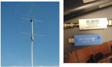
Básicamente son dos yagis de dos elementos montadas en un tubo de PVC a 90 grados entre sí y desfasadas por un tramo de cable coaxial de 75 ohms. Existen muchas descripciones en la web, yo elegí la más sencilla:
