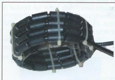
Imagen 10. Choque con núcleos de ferrita bobinado
