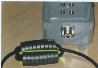
Imagen 11. Montaje del choque de RF
